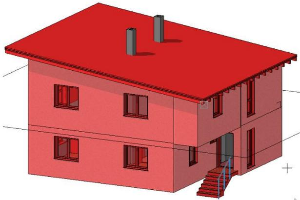
Erstellen Sie Hilfslinien für das Pultdach: 120cm Überstand auf der Firstseite, 66cm an der Traufe und 60cm am Ortgang. Setzen Sie ein Dach Steild Däm. zwischen Sparren mit 7° Neigung und 245cm Höhe in der Innenecke der Wand (siehe Bild).
