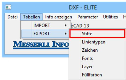
DXF (AutoCAD) und ELITECAD unterscheiden sich in der Zuweisung von Stiftnummer und Farbe. Ausserdem verfügt ELITECAD über 1024 Stifte, DXF hingegen nur über 256.
