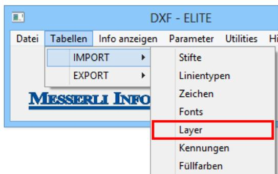
Diese Funktion dient zum Zuordnen der Bezeichnung DXF-Layer zur ELITECAD-Layer.
