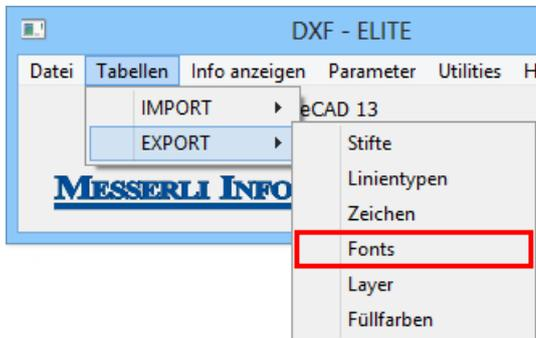
Diese Funktion dient zum Zuordnen von ELITECAD-Fonts zu DXF-Fonts.
