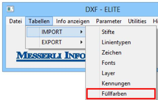
Wie bei den Stiften unterscheiden sich die Füllfarben (Flächenschraffuren) bei DXF (AutoCAD) und ELITECAD in der Zuweisung von Nummer und Farbe.
