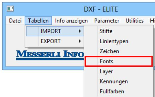
Diese Funktion dient zum Zuordnen von DXF-Fonts zu ELITECAD-Fonts mit optionaler Zeichenbreite (Space) durch Beistrich von der Font-Nummer getrennt.
