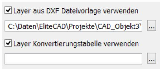
Die Option "Layer aus DXF Dateivorlage verwenden" kann genutzt werden, um einer DWG-Datei zusätzliche Layer aus einer Vorlage mitzugeben.
