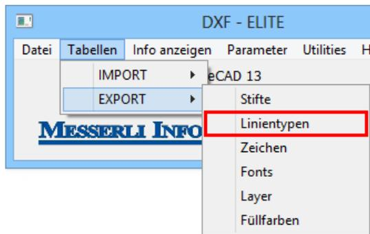
Diese Funktion dient zum Zuordnen der ELITECAD-Linientypen zu den DXF-Linientypen.
