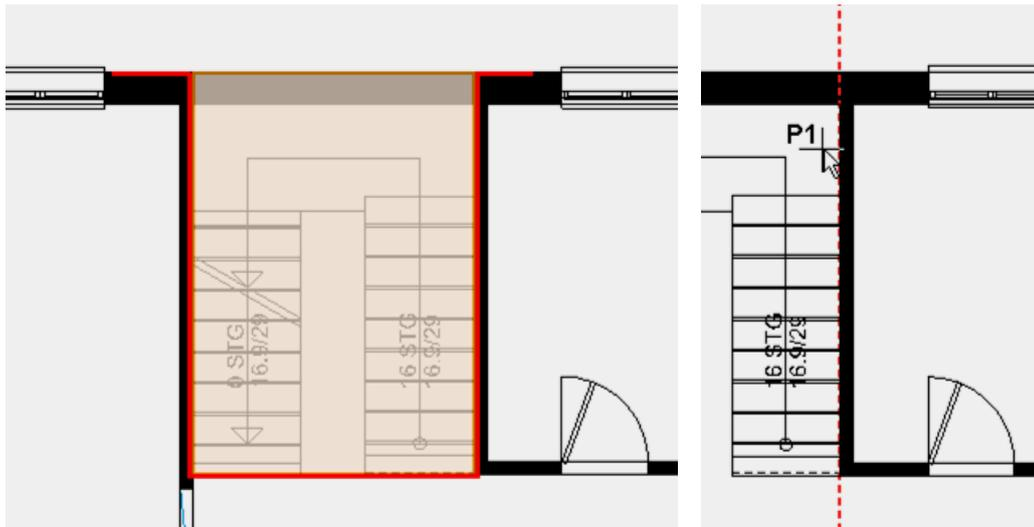
1. Setzen Sie eine Hilfslinie mit der Funktion PARALLELE GERADE mit Abstand 0 an die Treppenhauswand **P1**.
