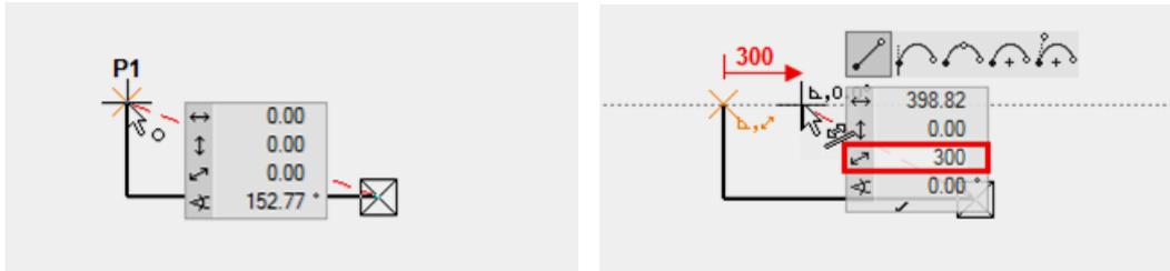
6. Anstatt die temporären Hilfslinien zu benutzen, kann die Lage des neuen Punkts über einen x- und y-Wert bestimmt werden. Achten Sie darauf, dass der Cursor auf keiner temporären Hilfslinie steht, drücken Sie die [Tabulator]-Taste und tragen Sie beim x-Wert **0** und beim y-Wert **-300** ein > **P5**.
