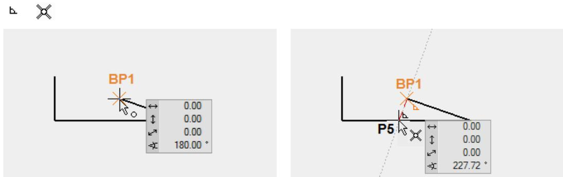
7. Das nächste Element ist ein Kreisbogen. In der Eingabehilfe sind zusätzliche Zeichnungsfunktionen wie tangentialer Kreisbogen, Bogen durch 3 Punkte,... verfügbar.
